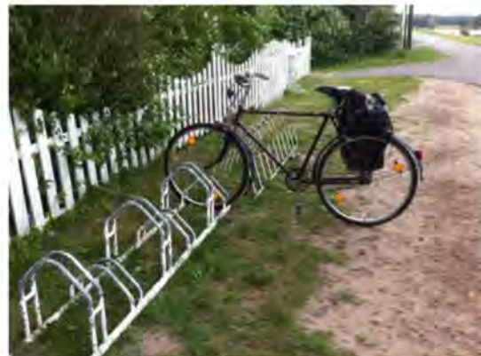
Abbildung 2: Typ Felgenklemmer (ungeeignet)
